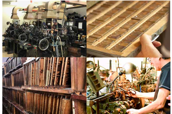
築地活字は100年の歴史を紡ぐ活字鋳造会社。常時20~25万個に及ぶ母型を保有し、4pt~42ptまで活字を鋳造できる日本国内でも数少ない活字鋳造技術を継承。右下の写真は活字鋳造に取り組む活字鋳造職人 大松初行氏。写真:木口章人、藤元秀征
